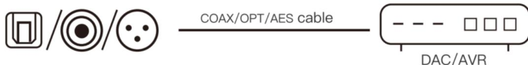
注：\* 同軸/光/AES 出力は、最大ステレオ PCM 192KHz 24bit および DOP64 に対応しています。
