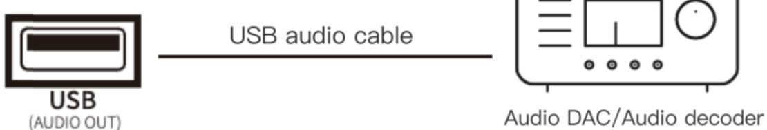
注：\* USB オーディオ出力は、最大 DSD512 ネイティブおよび PCM 768KHz 32bit に対応しています。
