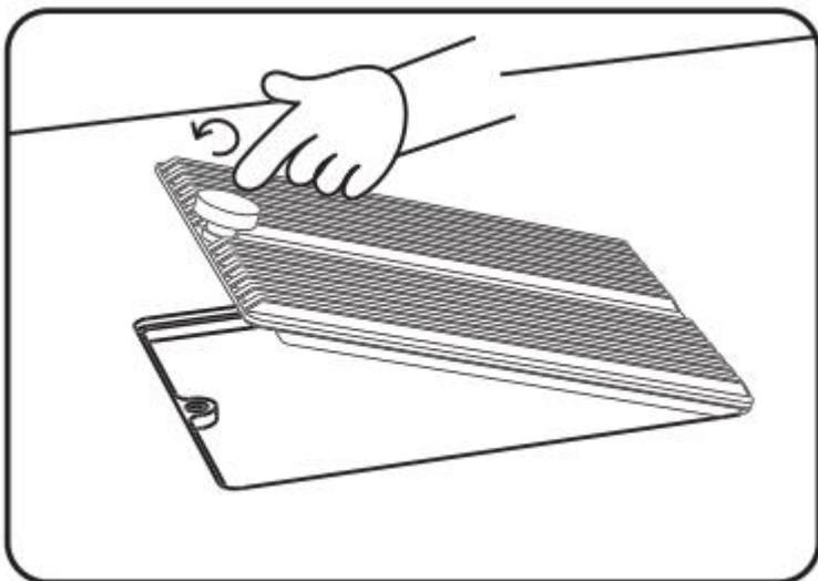
2. SSD 固定用のクリップを外し、慎重に SSD を挿入してからクリップをはめ、蓋をしてスクリューを締めます。
